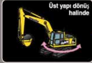
İş ekipmanının çalışması için motora gaz verildiği sırada elektrik gücü motora destek olur
