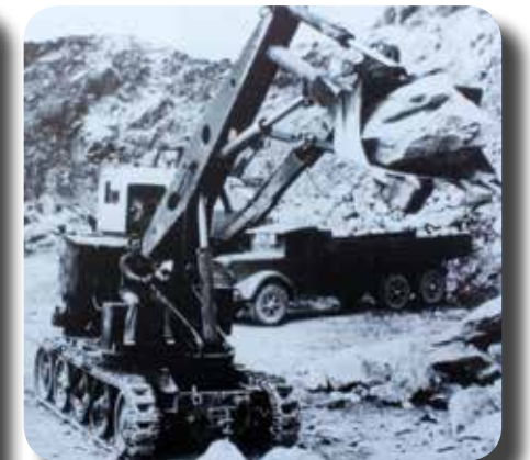
Yumbo S25 Dünyanın ilk 360 derece dönüşlü hidrolik ekskavatörü - 1954
