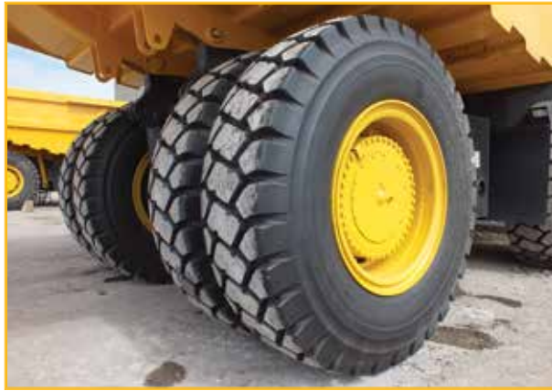
Makinelere maden sahalarına özel Bridgestone 27.00R49 model kaya kamyonu lastiği kullanılıyor.
