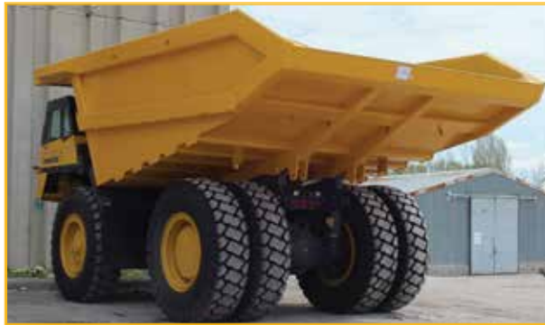
Makinelere maden sahalarına özel Bridgestone 27.00R49 model kaya kamyonu lastiği kullanılıyor.
