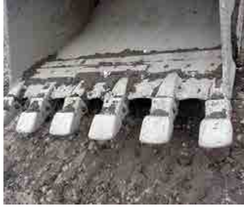
Resim 2: Ağır hizmet, aşınmaya karşı dayaklı tırnaklar
