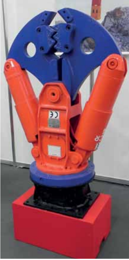
İnan Makina, 4-10 tonluk ekskavatör ve kazıcı-yükleyiciler için 360 derece dönebilen mini yıkım makası üretti.
