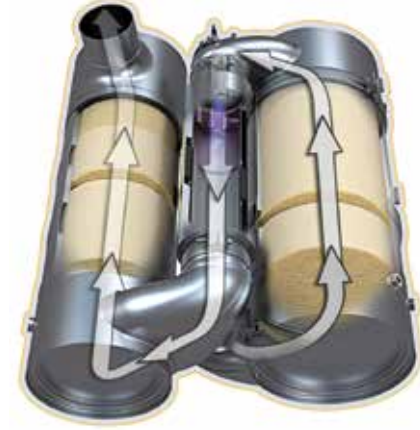
Cat Temiz Emisyon Modülü (CEM) DPF, SCR, AMOX ve DOC sistemleri, Stage IV fazı için Caterpillar tarafından geliştirilen CEM bünyesinde bütünleşik bir şekilde yer alıyor.
