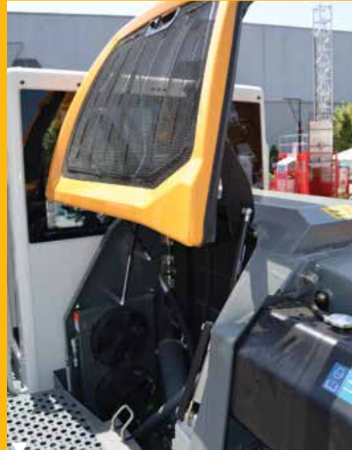
Soğutma modülü kabinin hemen arkasında konumlandırılmış
