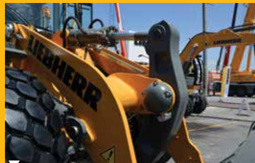
Yeni kapalı ön kova otomatik seviyeleme sistemi
