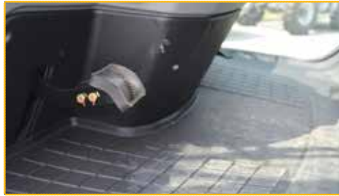
Hassas ve hızlı çalışma imkanı veren inching pedalı
