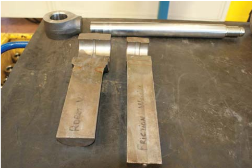
Hidrolik silindir imalatında kullanılan "friction welding" metodu ile parçalar, dönerek oluşturdukları yüksek ısı (1,000-1,100 derece) altında birbirlerine tam olarak kaynaşıyorlar. Parçalar arasında boşluk kalması ve kaynaktan kırılma ihtimali kalmıyor.
