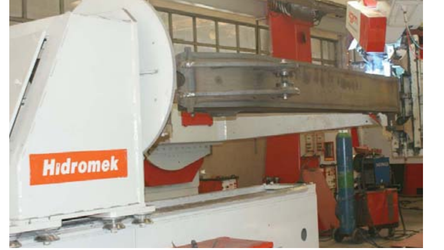
Yıllık 10.000 adetlik üretim için 5 adet yeni robot kaynak makinası alınmış. Makinalardaki referans noktalarda hariç tüm kaynakları bu robotlar yapıyor
