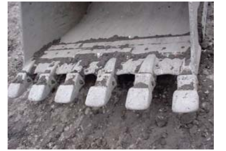
Resim 2: Ağır hizmet, aşınmaya karşı dayaklı tırnaklar
