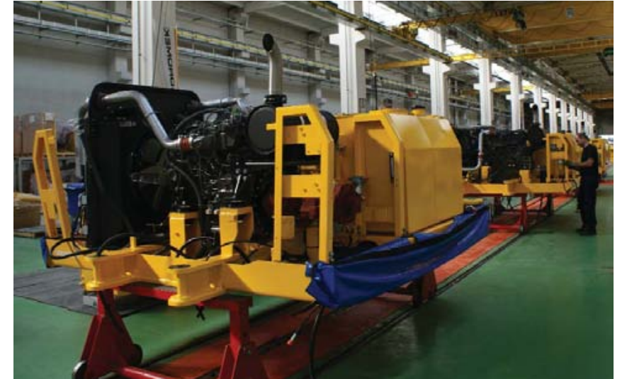
Çift üretim hattının bir tarafında alt şase, diğer tarafında üst şase montajı yapılıyor. İki bölüm birleştikten sonra kabin, bom, arm ve diğer ekipmanlar ekleniyor.
