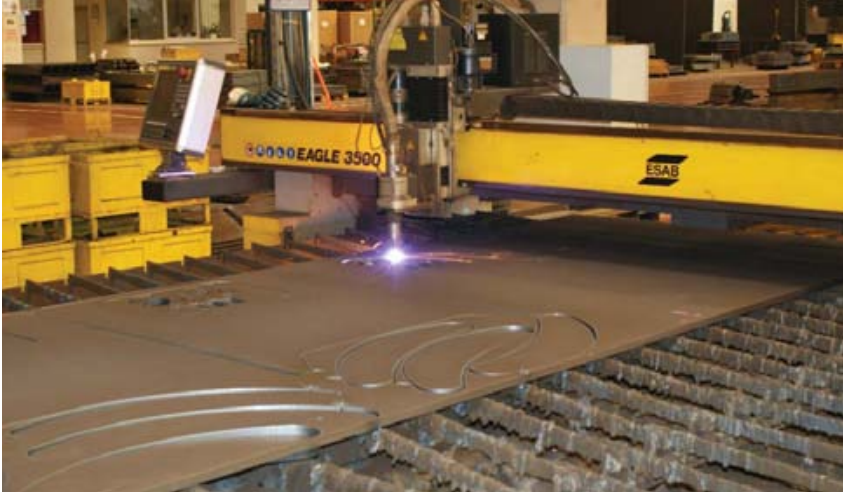
Su altı ve su üstü plazma kesim tezgahları, 600 tonluk presler, 24 robot kaynak makinası ve diğer talaşlı imalat makinaları ile ayda yaklaşık 8,000 ton sac işleniyor.
