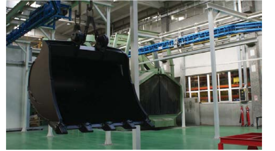
Kaynaktan çıkan parçalar raylı sistem üzerinde sırayla kumlama, boyanın daha iyi tutması için fosfat kaplama, temizlik, boyama ve kaplama işlemlerinden geçiyor.
