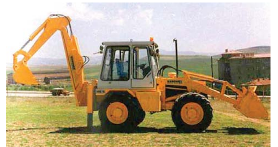
1991 - Dünyanın ilk dört tekerden çekişli ve dört tekerden direksiyon kumandalı Kazıcı-Yükleyici iş makinesi HMK 100S üretili.
